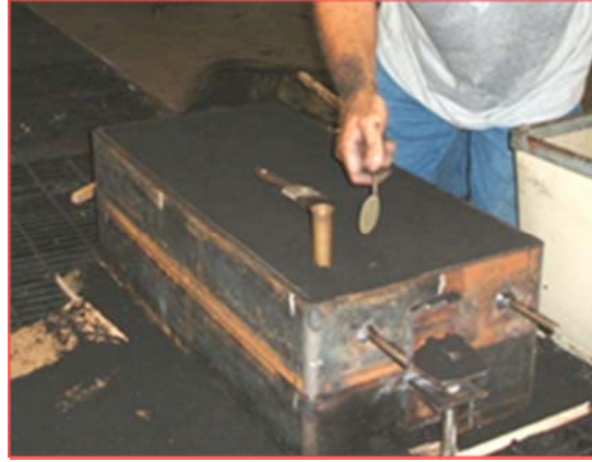
Fig. 20 Cutting Sprue & Pouring Basin
